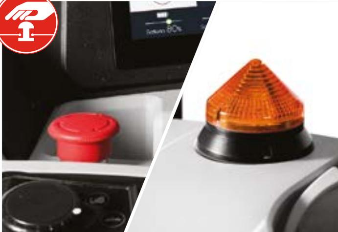
Emergency Stop. Im Notfall genügt ein Tastendruck, damit die Fahrt und sämtliche Funktionen sofort gestoppt werden. Die Blinkleuchte dient dazu, die Maschine während der Arbeit sichtbar zu machen, der Summer weist akustisch darauf hin, dass die Maschine im Rückwärtsgang fährt.
