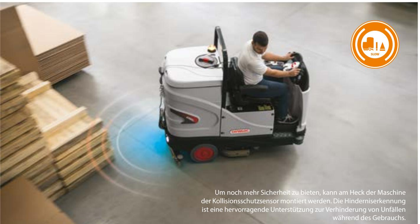
Um noch mehr Sicherheit zu bieten, kann am Heck der Maschine der Kollisionsschutzsensor montiert werden. Die Hinderniserkennung ist eine hervorragende Unterstützung zur Verhinderung von Unfällen während des Gebrauchs.
