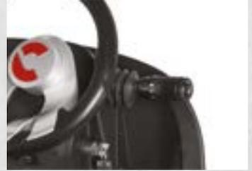
In der Nähe des Lenkers, an einer für den Bediener bequem zu erreichenden Stelle, befindet sich der Vorwärts-/Rückwärtsganghebel mit Auswahlmöglichkeit aus 3 voreingestellten Arbeitsgeschwindigkeiten.
