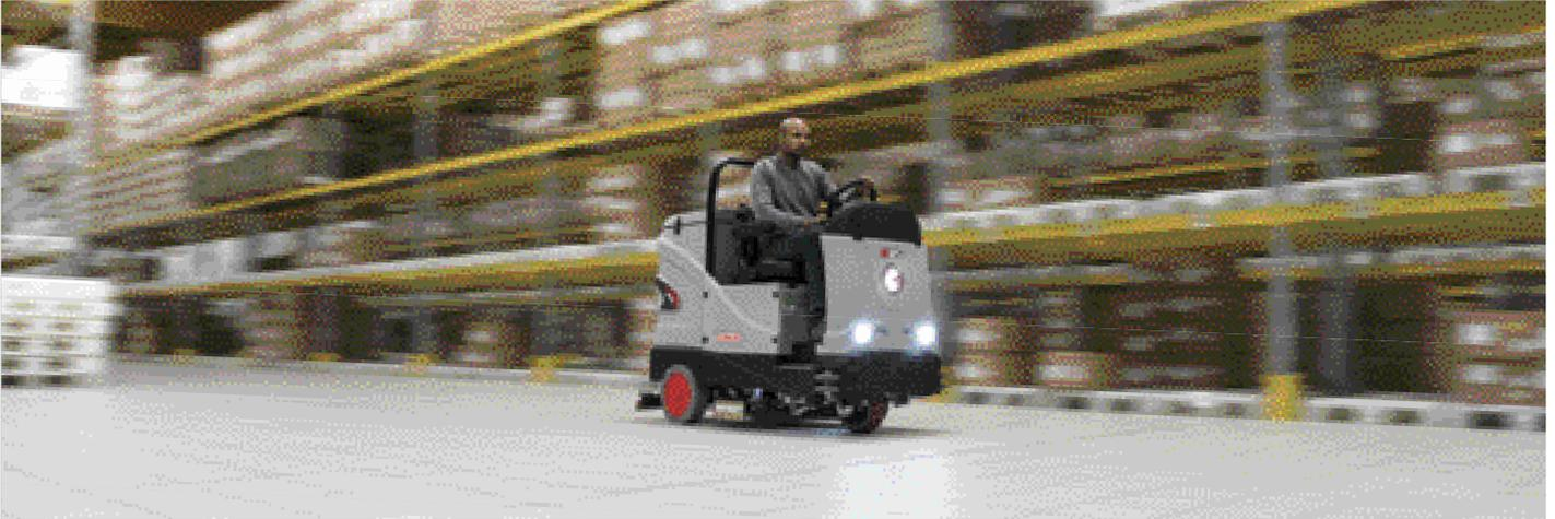
Rasche Reinigungsarbeiten für optimales Zeitmanagement: bis zu 8 km/h Fahrgeschwindigkeit. Ein auf der Lenkachse angebrachter Dauersensor erkennt die genaue Position des vorderen Antriebsrads und verringert automatisch bedarfsgemäß die Geschwindigkeit der Maschine. Der Sensor ermöglicht es der Maschine, sich flüssig und ohne Unterbrechung vorwärts zu bewegen.
