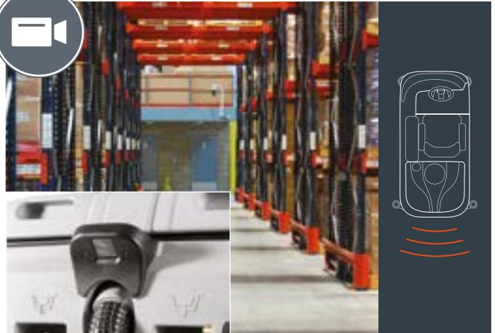
Die hintere Kamera der Bright Konfiguration unterstützt den Bediener dabei unter absolut sicheren Bedingungen eventuelle Hindernisse beim Rückwärtsfahren zu erkennen.
